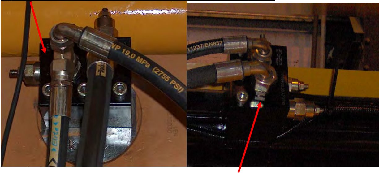
Pièce 21 ( valve équilibrage vérin télescope bras externe : cylinder 2-2) relief valve for external telescopic primary boom cylinder
